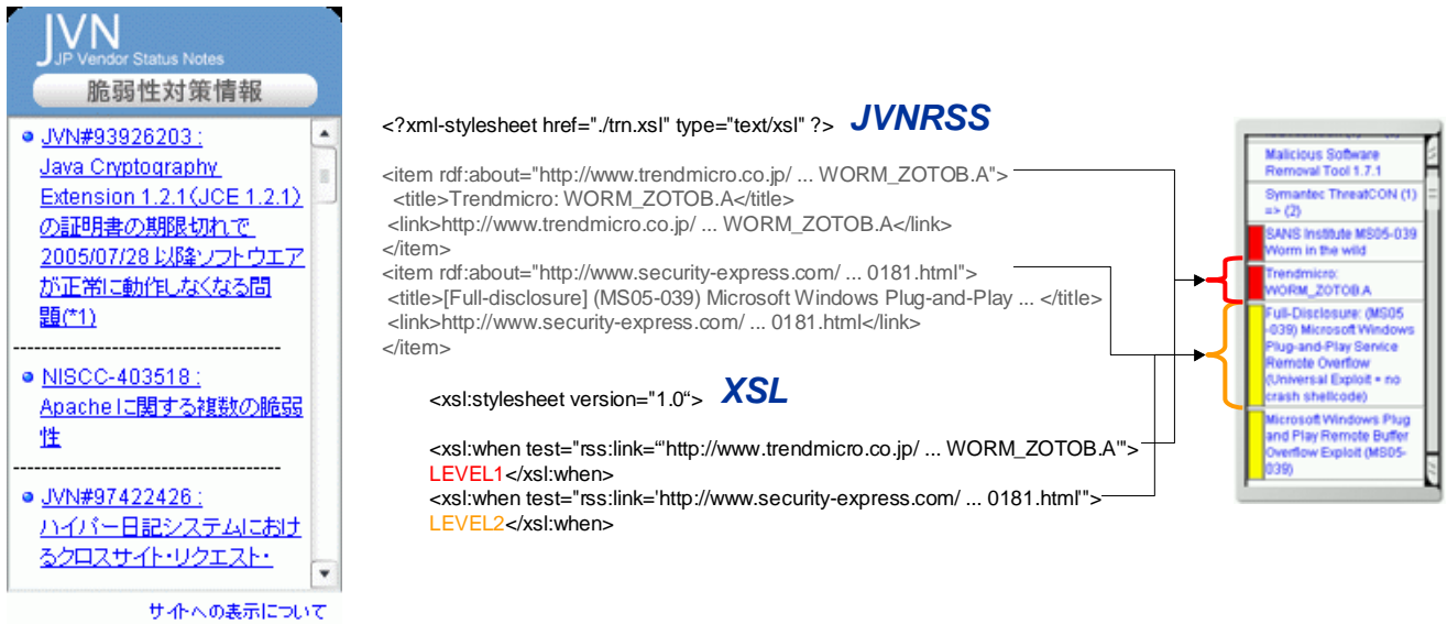
図 3 JVN RSS の Web 表示ツール: jvnbox(左), XSL_swf 仕様の box(右)
